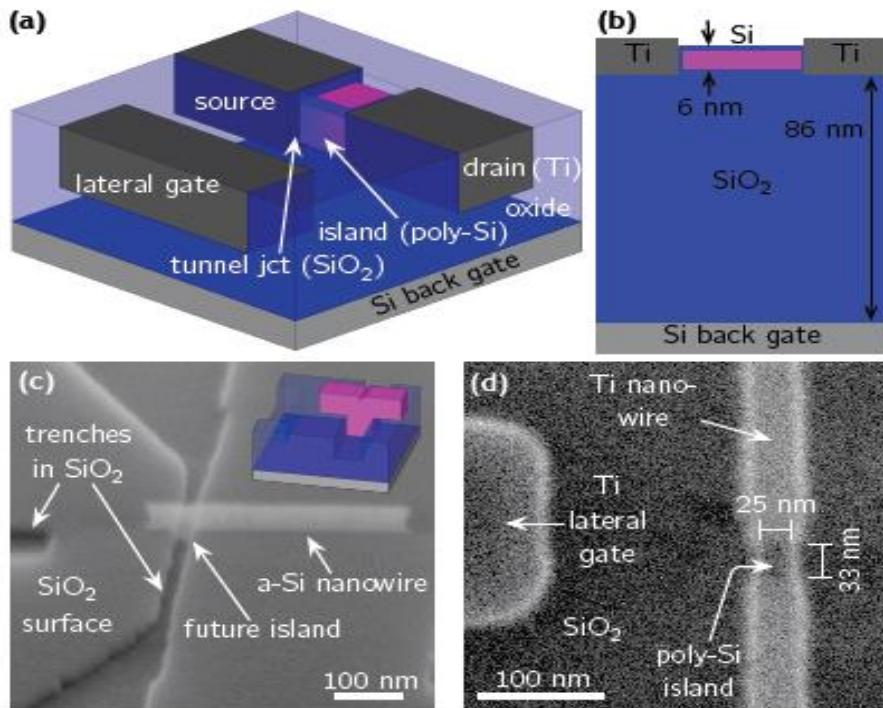
**Slika 18 . a)** Shematski prikaz tranzistora . **b)** Presjek shematskog prikaza sa odgovarajućim dimenijama . **c)** Bočna slika tranzistora u fazi izrade , učinjena skenirajućim elektronskim mikroskopom . Prikazuje nancijev sa dovodnom i odvodnom elektrodom , bočnu upravljačku elektrodu i silicijevu nanocijev koja se preklapa sa odvodnom/dovodnom elektrodom formirajući tranzistorski "otočić" **d)** Tlocrt izrađenog tranzistora učinjen pomoću skenirajućeg elektronskog mikroskopa
