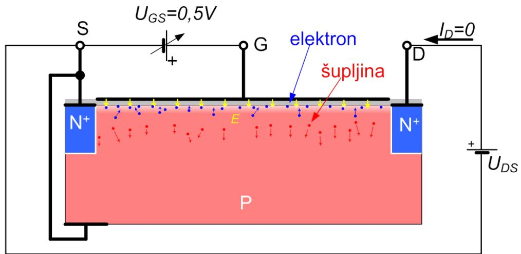
**Slika 10 . Povećanje koncentracije elektrona u površinskom sloju podloge**
