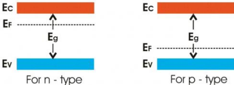
Slika 5. Dijagrami energetskih vrpci za ekstrinsične poluvodiče
