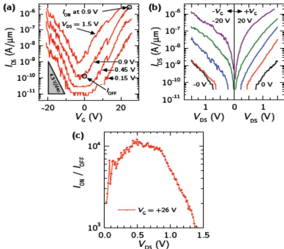
Slika 19 . a)  $I_{DS}$ - $V_G$  karakteristika za  $V_{DS} = 0.15 \text{ V}$ ,  $0.45 \text{ V}$ ,  $0.9 \text{ V}$  i  $1.5 \text{ V}$  b)  $I_{DS}$ - $V_{DS}$  karakteristika za pozitivne i negativne vrijednosti  $V_G$  c) Odnos  $I_{on}/I_{off}$  kao funkcija napona  $V_{DS}$
