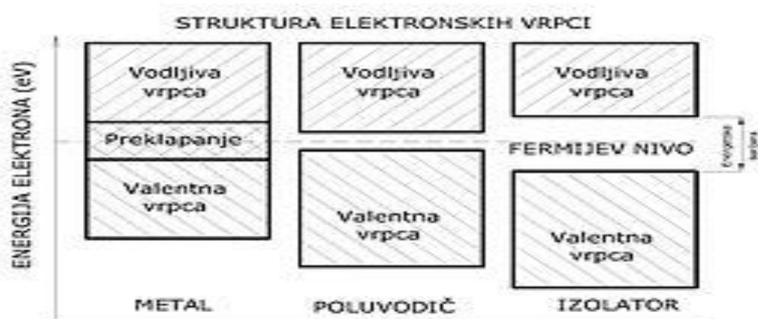
Slika 4. Diagrami energetskih vrpci za intrinsične poluvodiče
