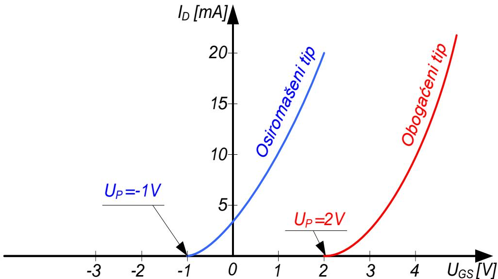
Slika 14. Prijenosna karakteristika osiromašenog N kanalnog tranzistora
