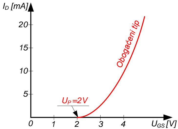
Slika 13. Prijenosna karakteristika obogaćenog N kanalnog tranzistora
