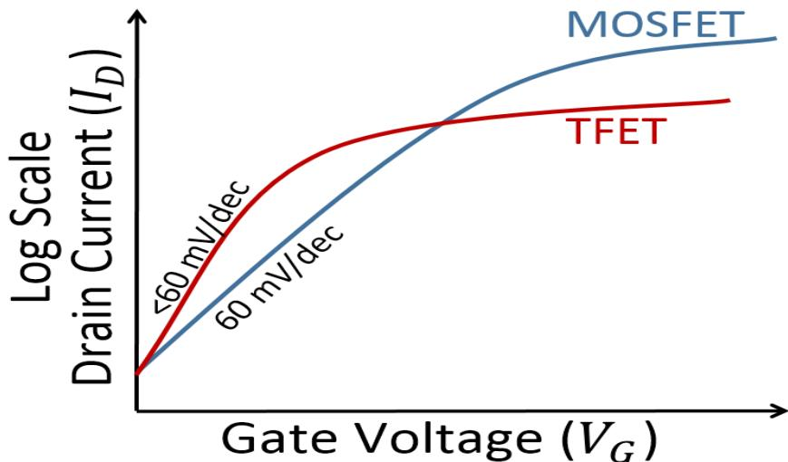
**Slika 17 . Usporedba prijenosnih karakteristika MOSFET i TFET tranzistora**
