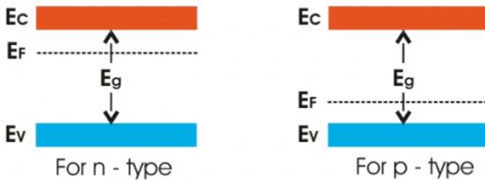
Slika 5. Dijagrami energetske vrpce za ekstrinzične poluvodiče
