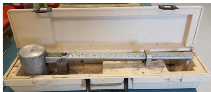
**Slika 18.** Uređaj za mjerjenje gustoće
