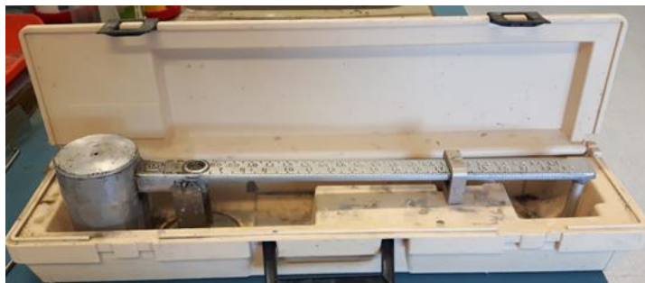
Slika 18. Uređaj za mjerenje gustoće
