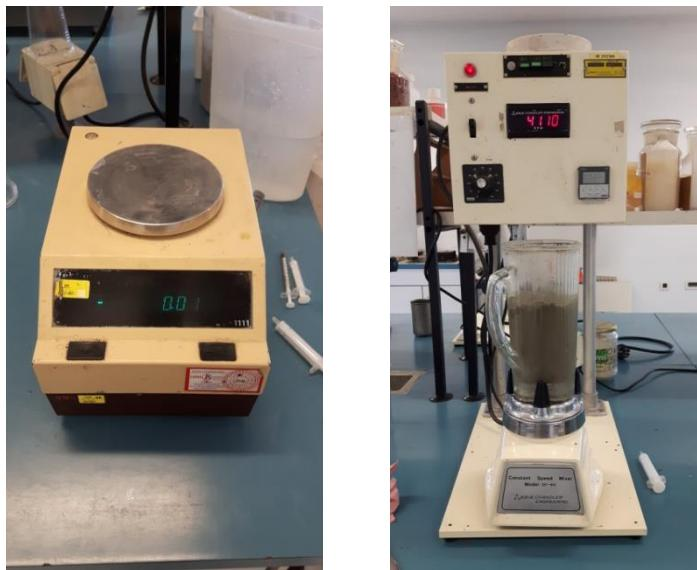
**Slika 17.** Eksperimentalna vaga (lijevo), laboratorijska mješalica (desno)
