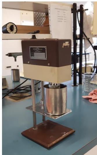
**Slika 19.** Rotacijski viskozimetar
