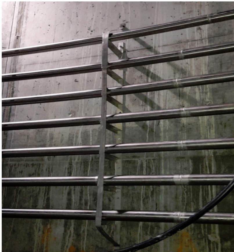
Slika 14 Grijaće cijevi u reaktoru [41]
