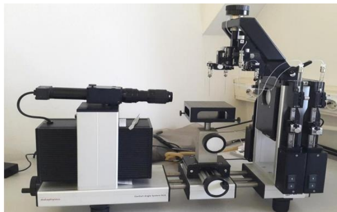
Slika 9. Goniometar DataPhysics OCA 20 Instrument
