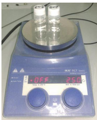
Slika 5. Polimerna otopina PCL-a na magnetskoj miješalici
