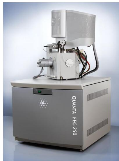
**Slika 10.** SEM mikroskop QUANTA 250, FEI
