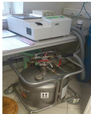
**Slika 12.** Diferencijalni pretražni kalorimetar Mettler Toledo DSC 822<sup>e</sup>
