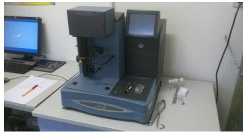
**Slika 11.** Termogravimetar Q500, TA Instruments
