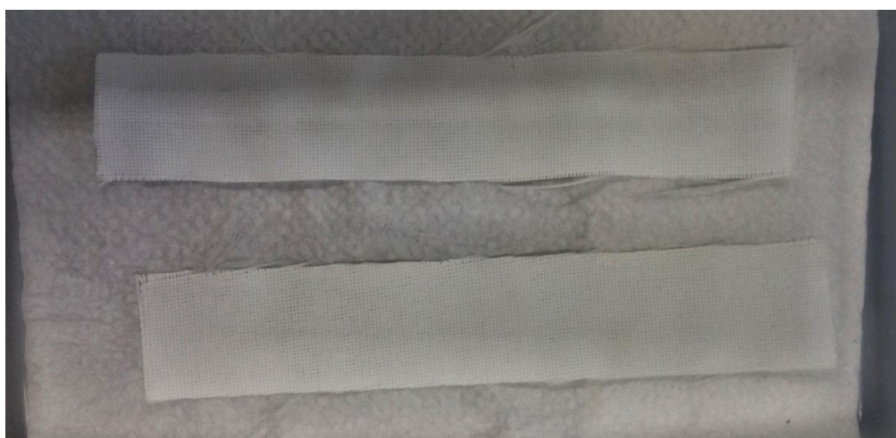
Slika 12. Prevlaka cinkovog oksida na staklenoj mrežici
