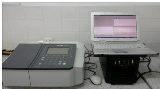
Slika 3.4. Spektrofotometar Shimadzu UV – 1800
