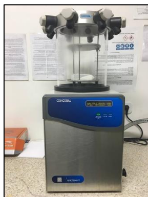
Slika 3.9. Liofilizator LABCONCO Free Zone
