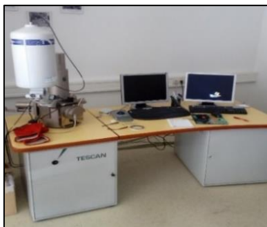
Slika 3.10. SEM – EDS Tescan Vega 5136 MM
