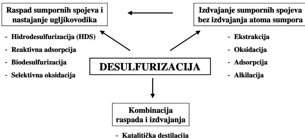
**Slika 4.** Klasifikacija procesa desulfurizacije prema načinu uklanjanja organskih sumporovih spojeva tijekom desulfurizacije<sup>9</sup>
