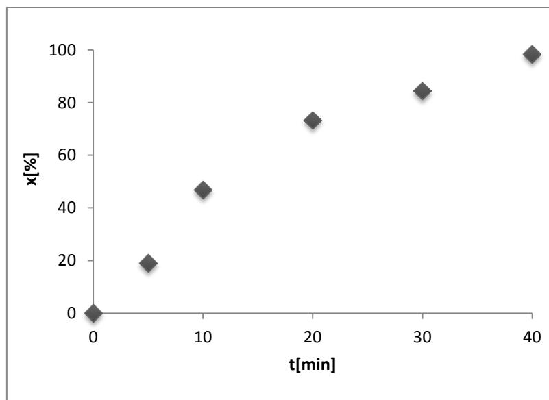
Slika 22. Konverzija DBT-a u ovisnosti o vremenu reakcije ( $T = 50^\circ\text{C}$ ,  $O:K=32,55:1$ , užv=70
