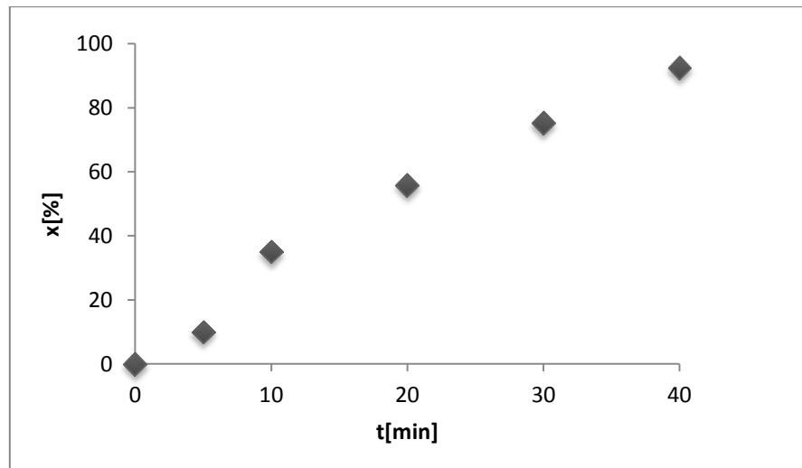
**Slika 24.** Konverzija DBT-a u ovisnosti o vremenu reakcije ( $T = 50^\circ\text{C}$ ,  $O:K=16,29:1$ ,  $uzv=70\text{ W}, 80\text{ \%}$ )
