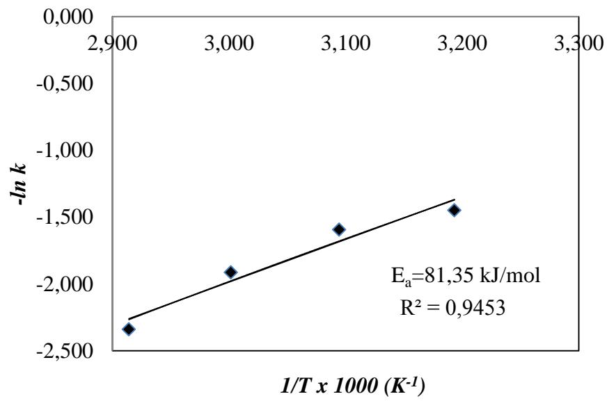
**Slika 39.** Grafički test Arrheniusovog izraza, određivanje  $A_r$  i  $E_a$
