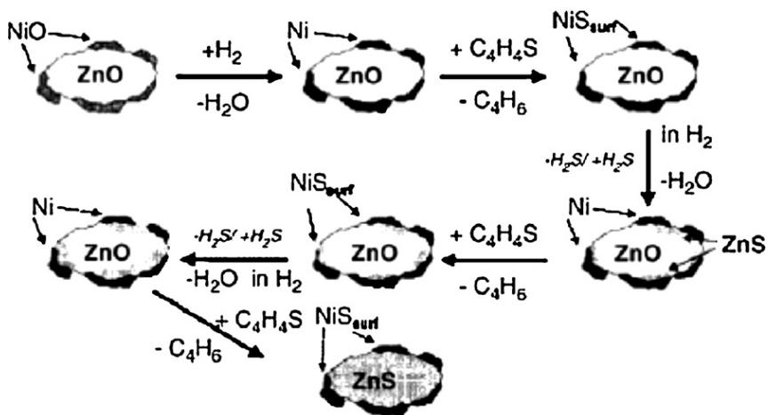
**Slika 7. Mehanizam reaktivne adsorpcijske desulfurizacije<sup>3</sup>**
