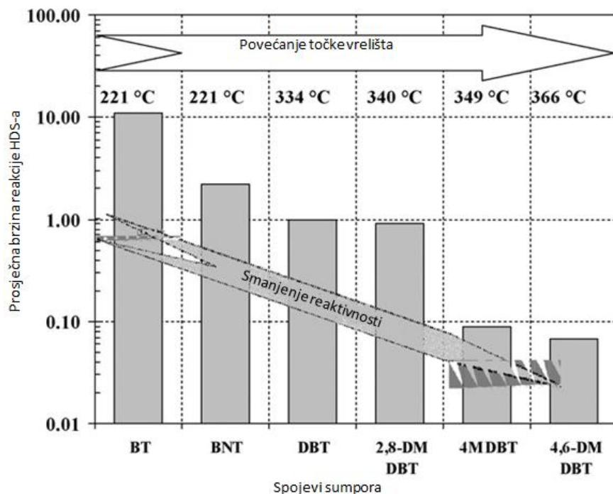
**Slika 5.** Reaktivnost sumporovih spojeva<sup>6</sup>
