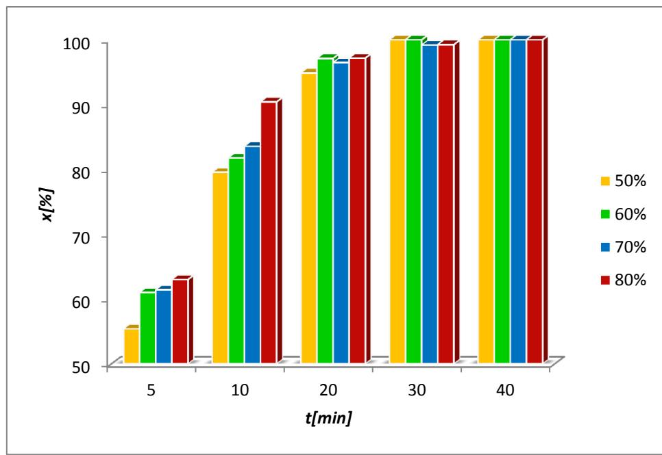
**Slika 35.** Konverzije DBT-a u ovisnosti o amplitudi ultrazvuka sange 70W i vremenu reakcije
