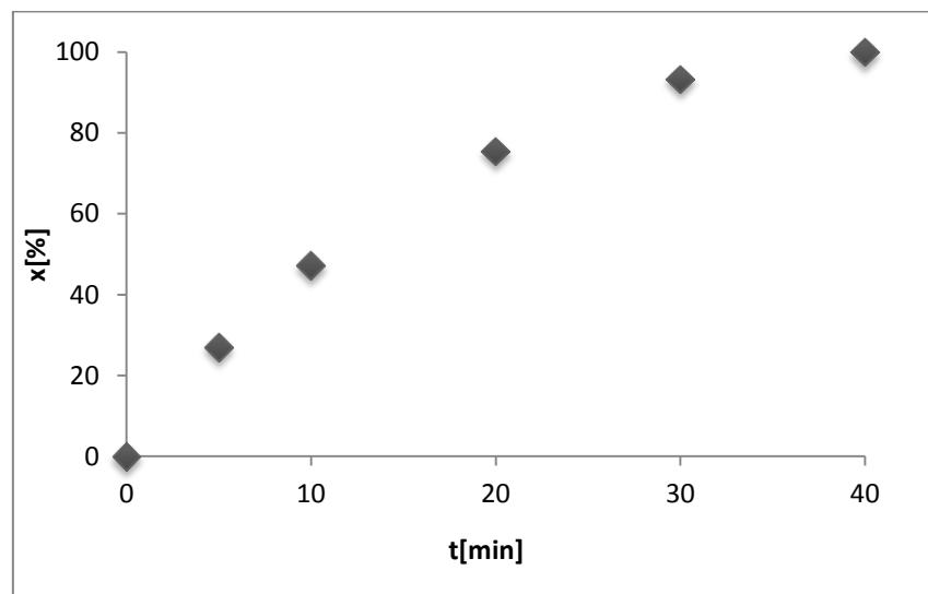
**Slika 23.** Konverzija DBT-a u ovisnosti o vremenu reakcije ( $T = 50^\circ\text{C}$ ,  $O:K=22,18:1$ ,  $uzv=70\text{ W}, 80\text{ \%}$ )
