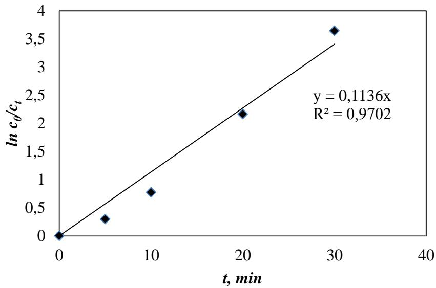
**Slika 38.** Ovisnost  $\ln (C_o/C_t)$  u vremenu ( $T= 60^\circ\text{C}$ ,  $O:K=22,18:1$ ,  $u_zv=70\text{W}$ , 80%)
