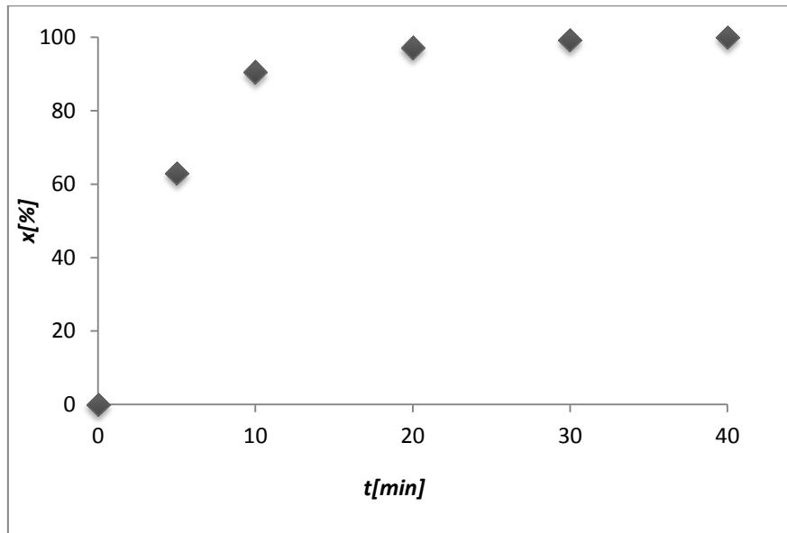
**Slika 36.** Konverzija DBT-a u ovisnosti o vremenu reakcije pri optimalnim uvjetima ( $T=70^{\circ}\text{C}$ ,  $O:K=22,18:1$ ,  $užv=70W$ , 80%)
