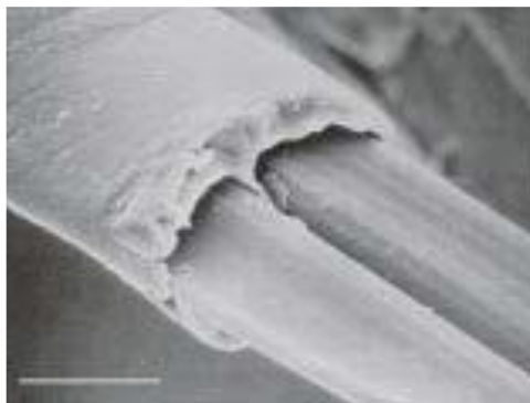
Slika 6. SEM mikrografija svilenkastog fibroina svile koji je prekriven sericinom
