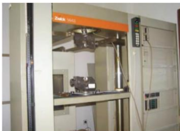
Slika 7. Univerzalna mehanička kitalica ZWICK 1445
