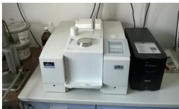
**Slika 5.** PerkinElmer, Spectrum One spektrometar
