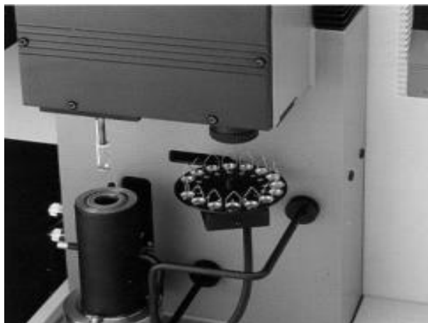
Slika 8. TGA analizator TA Instruments Q500
