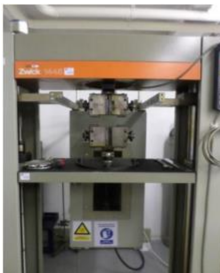
Slika 19. Mehanička kidalica Zwick 1445 39
