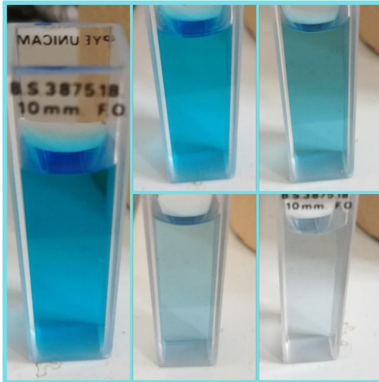
Slika 31. Obezbojenje uzoraka tijekom fotokatalize
