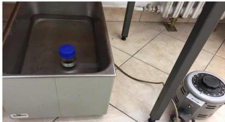
Slika 22. Ultrazvučna kupelj
