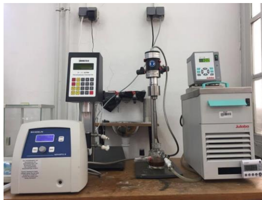
Slika 18. Ultrazvučna sonda Bandelin sonoplus HD 3200
