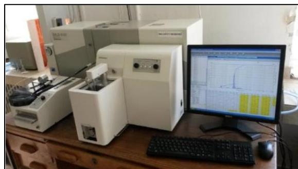
Slika 16. Uređaj laserske difrakcije SALD-3101 (Shimadzu, Japan)
