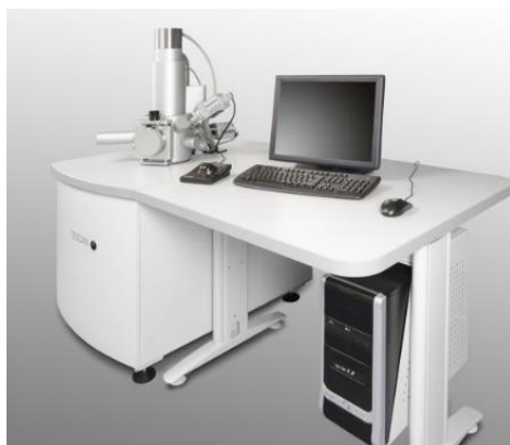
Slika 17. Tescan Vega 3 SEM [ http://btmm.bnu.edu.cn ]
