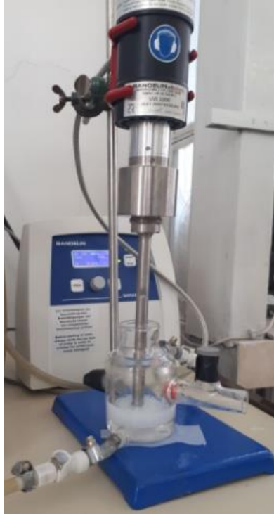
Slika 10. Raspršivanje nanočestica sa ultrazvučnom sondom
