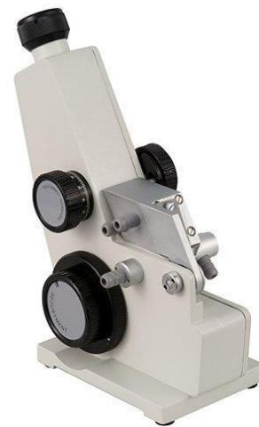
**Slika 3.** Abbeov refraktometar
