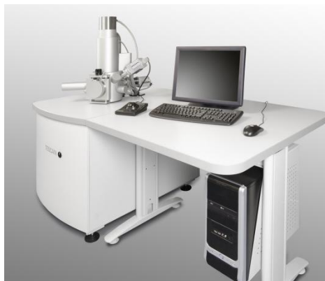
Slika 18. Uređaj pretražne elektronske mikroskopije, Tescan Vega 3 SEM
