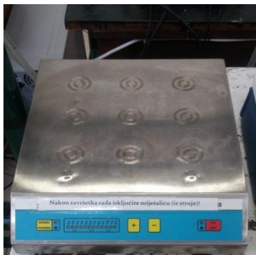
Slika 24. Magnetsko miješalo, Tehtnica Rotamix 609 MM
