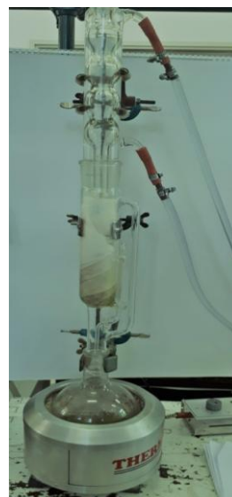
Slika 23. Aparatura za Soxhlet ekstrakciju
