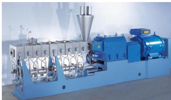
Slika 11. Prikaz pužnog (vijčanog) ekstrudera
