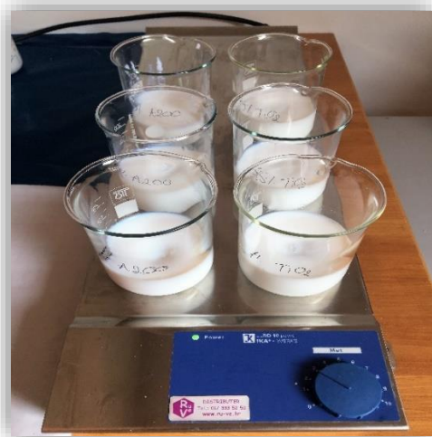
Slika 15. Zamiješavanje BA-co-MMA/nano-SiO 2 i BA-co-MMA/nano-TiO 2 kompozita
