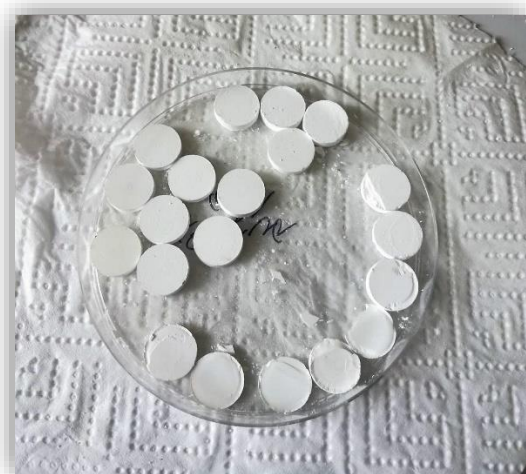
Slika 19. Pastile TiO 2 punila pripravljene prešanjem u kalupu
