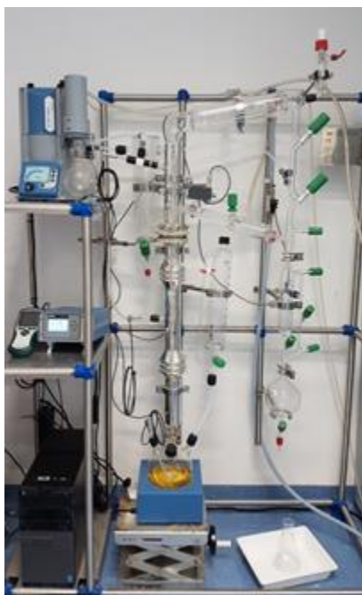
Slika 19. Aparatura za šaržnu destilaciju UNIT DN30/ 2I
