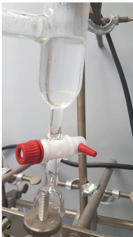
Slika 30. Prikaz raslojavanja 2- metiltetrahidrofurana i vode
