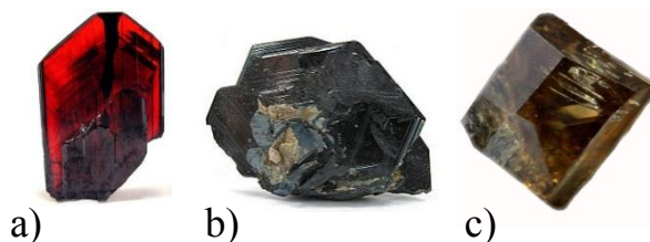
Slika 7. Polimorfne modifikacije TiO 2 a) brukit, b) rutil i c) anatas
