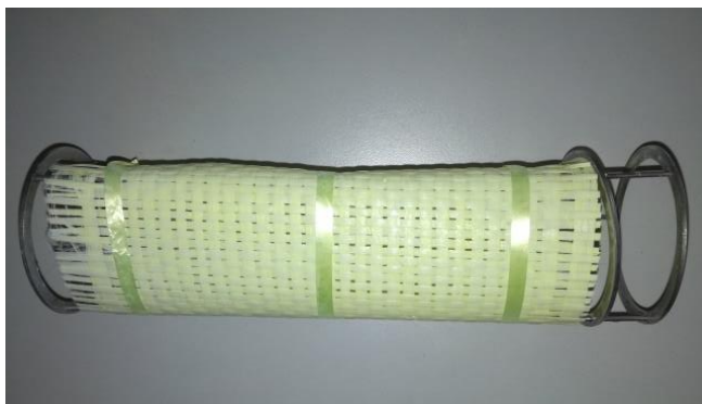
Slika 3.7. Mrežica od staklenog vlakna na stalku
