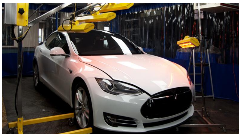
Slika 11. IC sušenje premaza automobila
