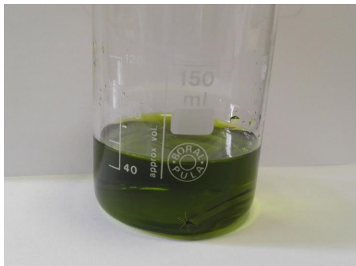
Slika 3.4. Prethodno oblikovana pločice Al/Al 2 O 3 u otopinama za pripremu monolitnih katalizatora.
