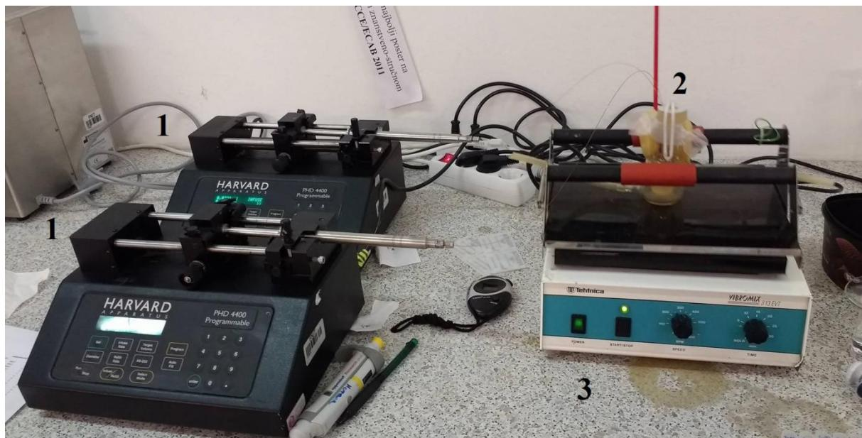
**Slika 3.3.** Aparatura za provođenje eksperimenta u kotlastom reaktoru s dotokom koja se sastoji od: 1) klipnih pumpi, 2) tiskalice, 3) tresilica
