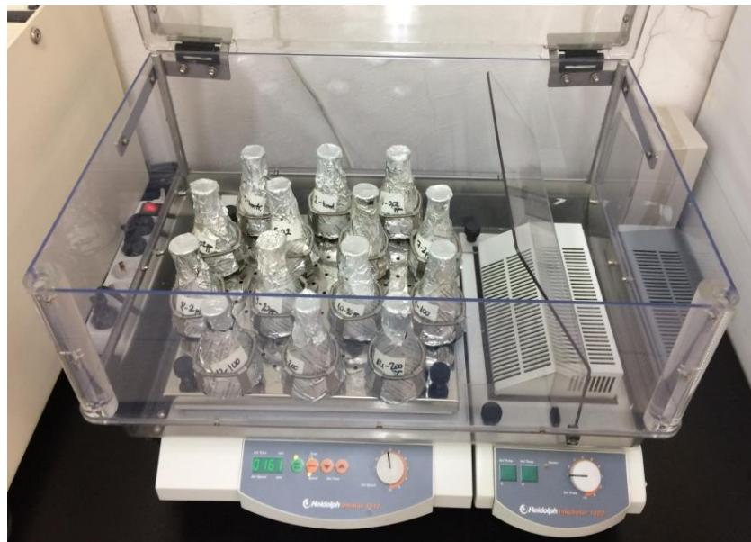
Slika 3.1. Provedba pokusa biorazgradnje na termostatiranoj rotacijskoj tresilici.
