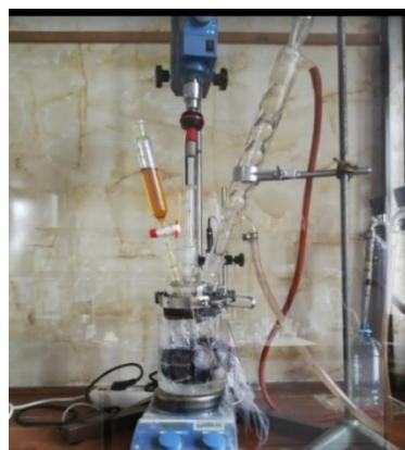
**Slika 3.3.** Aparatura za sintezu PPy/TiO<sub>2</sub> kompozitnog fotokatalizatora
