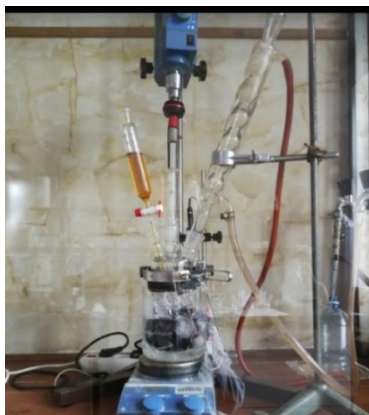
Slika 3.3. Aparatura za sintezu PPy/TiO 2 kompozitnog fotokatalizatora
