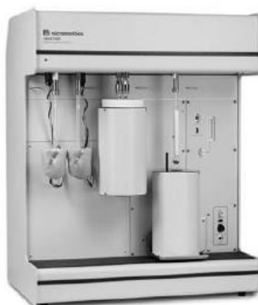
Slika 3.5. Uređaj za plinsku adsorpcijsko-desorpcijsku analizu Gemini 2380, Micromeritics
