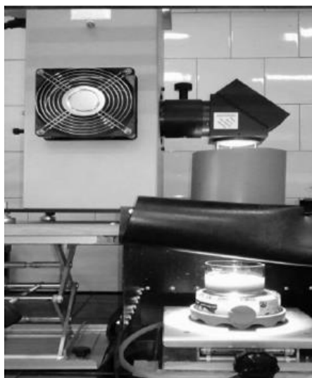
Slika 3.6. Simulator Sunčevog zračenja, Oriel Newport (lampa: Osram XBO 450W )
