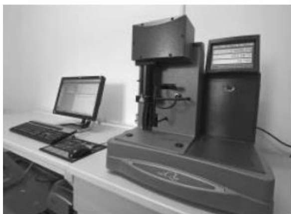
Slika 3.2. Termogravimetar Q500, TA Instruments
