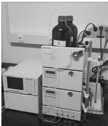
Slika 3.7. Tekućinski kromatograf visoke učinkovitosti LC-10, Shimadzu
