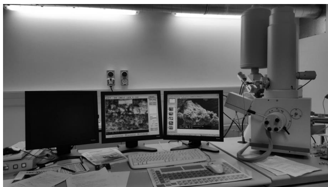
Slika 3.3. Pretražni elektronski mikroskop (SEM) XL30S FEG, Philips
