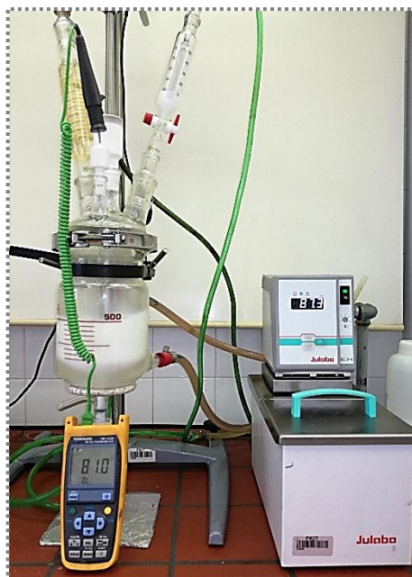
Slika 38. Aparatura za emulzijsku polimerizaciju
