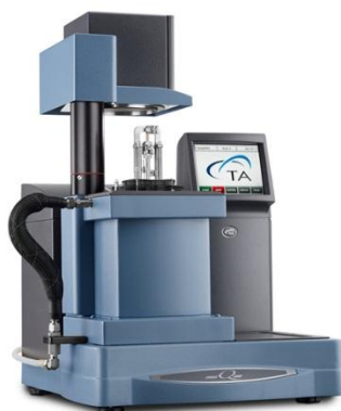
Slika 45. Termogravimetar, TA Instruments Q500
