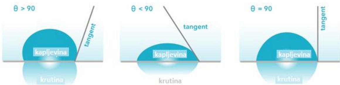
Slika 31. Kontaktni kut kapi na krutoj površini 45
