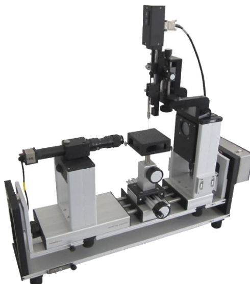
Slika 43. Instrument za mjerenje kontaktnog kuta DataPhysics OCA 20
