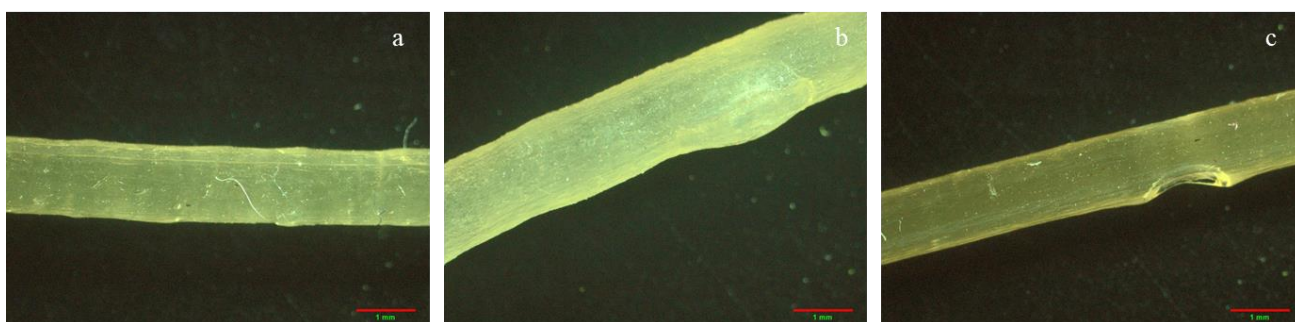
Slika 24. Mikrografije filamenata: a) PVA FF 10% 150, b) PVA FF 10% 160, c) PVA FF 10% 170 pri uvećanju 1,25x
