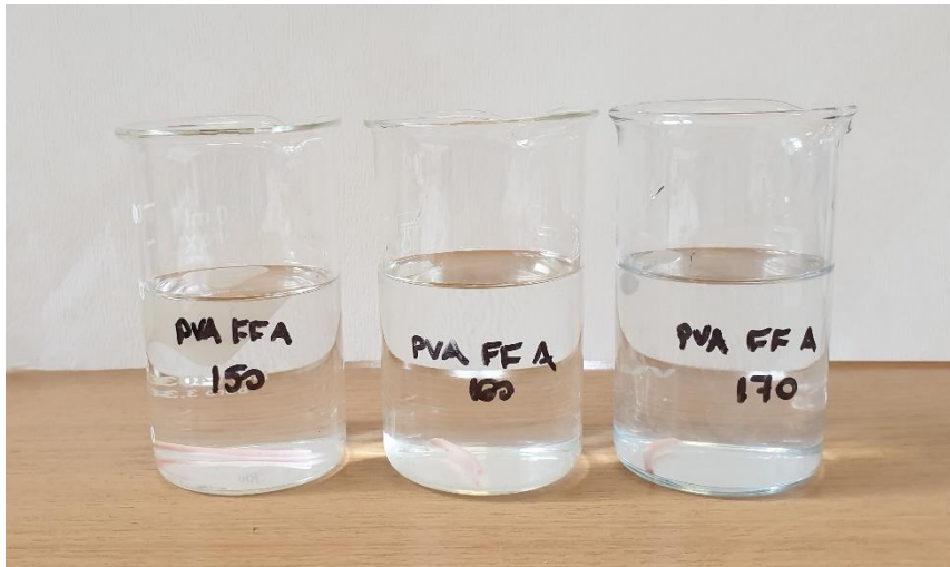
Slika 14. Test bubrenja za filamente PVA Atlas dobivene pri različitim temperaturama
