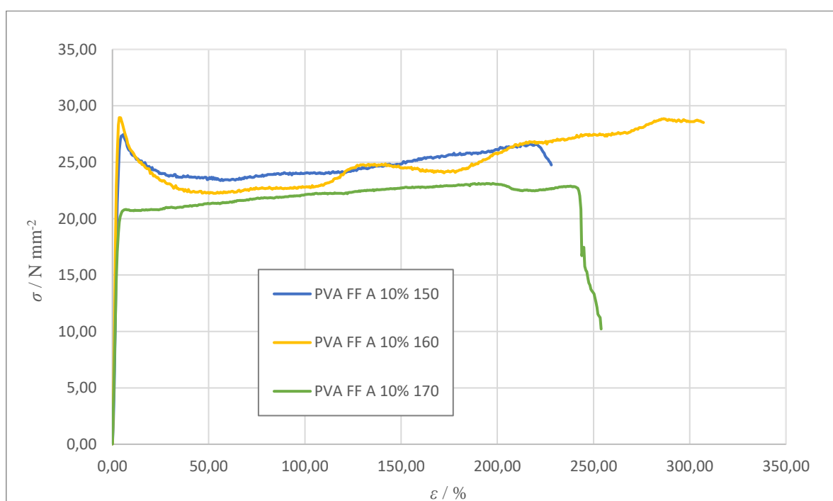
Slika 28. Dijagram naprezanja za uzorke filameta PVA Formfutura Atlas
