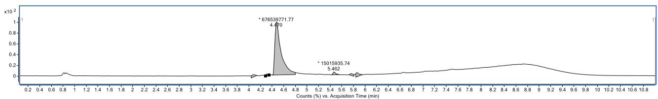
**Slika 11.** Kromatogram LD-1 izloženog temperaturi od 100 °C
