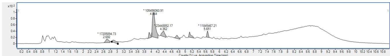
**Slika 26.** Kromatogram LD-1 izloženog fotolizi UV/VIS (500 Wh/m<sup>2</sup>)
