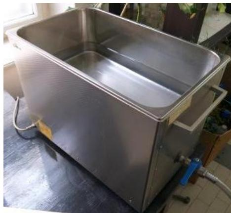
**Slika 3.** Ultrazvučna kupelj Bandelin Sonorex Digital 10 P korištena za pripremu uzorka
