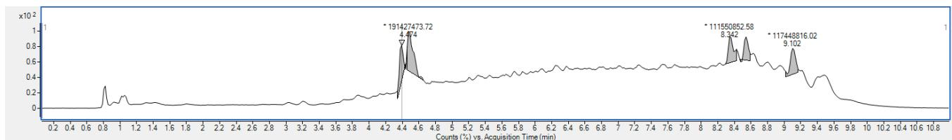
**Slika 12.** Kromatogram LD-1 izloženog fotolizi UV/VIS (500 Wh/m<sup>2</sup>)
