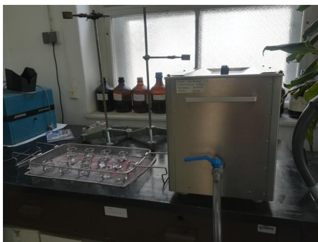
Slika 18. Ultrazvučna kupelj SONOREX DIGITAL 10 P, Bandelin, Berlin, Njemačka
