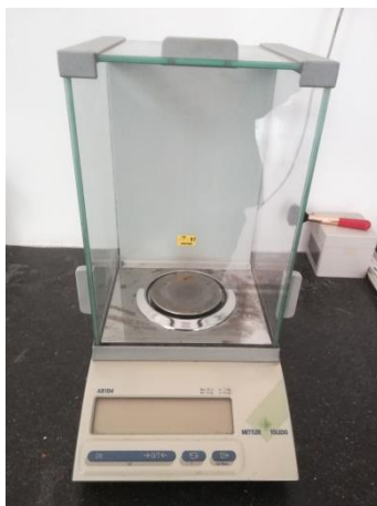
Slika 17. Analitička vaga Mettler Toledo AB104
