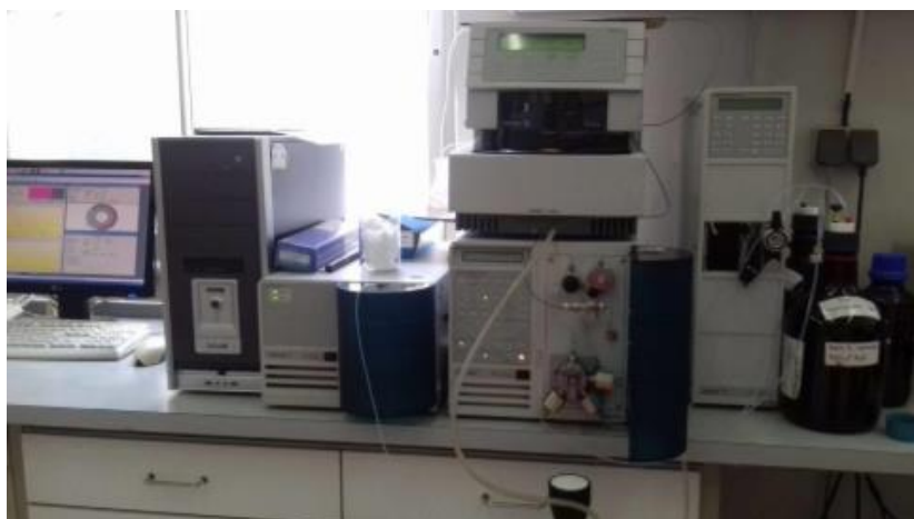
Slika 21. Tekućinski kromatograf visoke djelotvornosti, Varian ProStar 500
