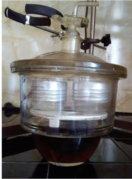
Slika 3.3.5.1: Aparatura za ispitivanje propusnosti vodene pare
