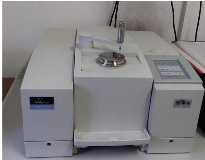
Slika 3.3.2.1 FTIR spektrometar, Perkin Elmer Spectrum One Spectrometer s ATR modulom
