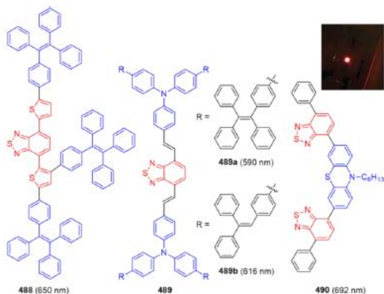
Slika 27. Prikaz struktura i maksimuma emisije crvenih emitera.
