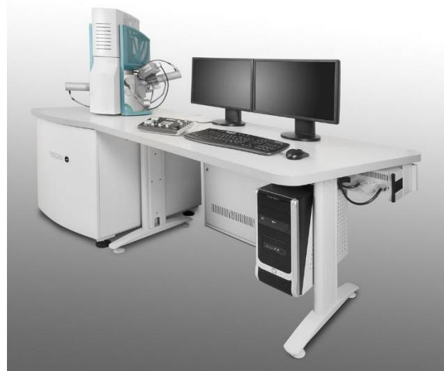
Slika 3.4.4. Uređaj za SEM Tescan Vega III Easypore
