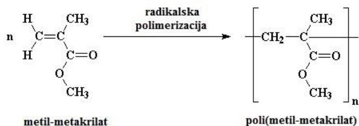
Slika 2.2.3. Dobivanje poli(metil-metakrilata) iz monomera<sup>14</sup>
