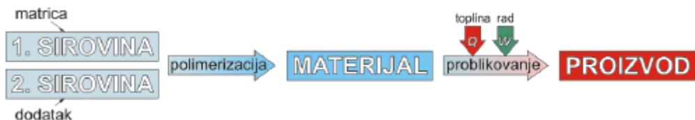
Slika 2.1.1. Blok shema izrade proizvoda od kompozita<sup>3</sup>
