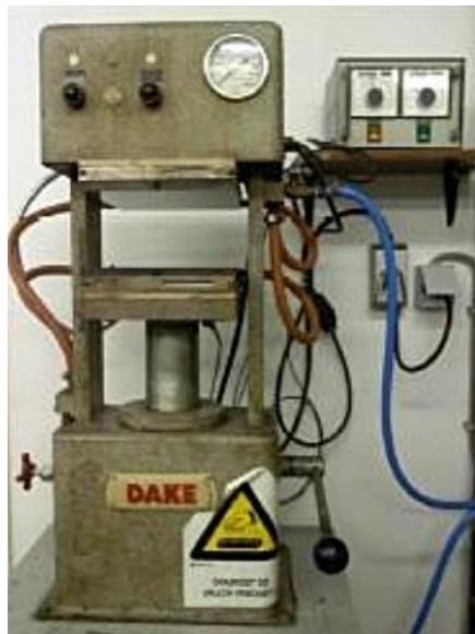
Slika 3.3.2. Hidrauličko hladilo Dake
