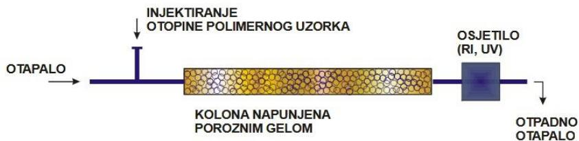
Slika 2.5.1. Shema rada GPC uređaja
