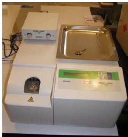
Slika 3.4.2. Uređaj Mettler Toledo DSC823e
