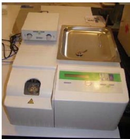
Slika 3.4.2. Uređaj Mettler Toledo DSC823e
