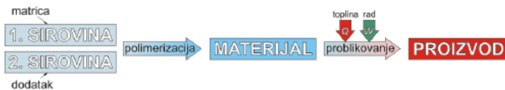
Slika 2.1.1. Blok shema izrade proizvoda od kompozita 3
