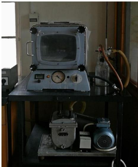
Slika 3.2.2. Vakuumski sušionik
