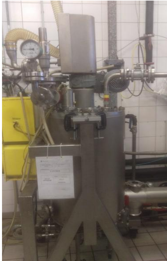
Slika 12. Filtarski sušionik od 125 L (Proizvođač: Giovanola Freres S.A.)
