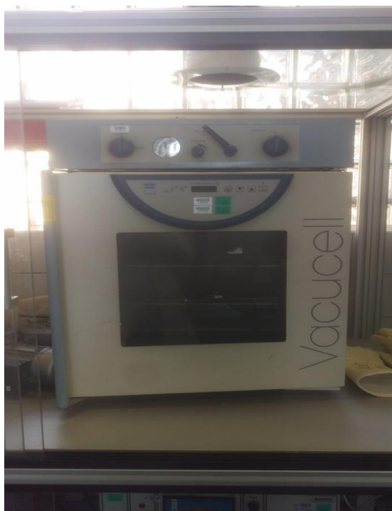
Slika 10. Vakuom sušionik VacuCell (Proizvođač: MMM Medcenter Einrichtungen GmbH)
