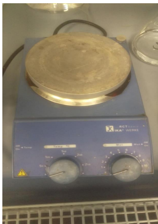
Slika 9. RCT basic magnetska miješalica (Proizvođač IKA-werke)
