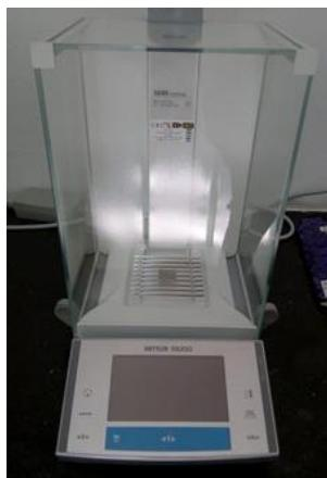
**Slika 3.1.** Analitička vaga Mettler Toledo XA105DU
