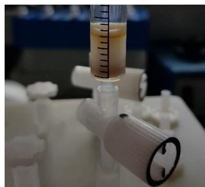
**Slika 3.22.** Sloj bojila na koloni vidljiv nakon propuštanja uzorka diesela
