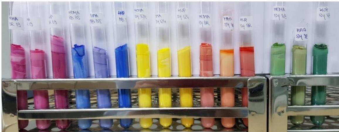
**Slika 3.15.** Polimeri s otiskom molekule nakon 24 h u sušioniku
