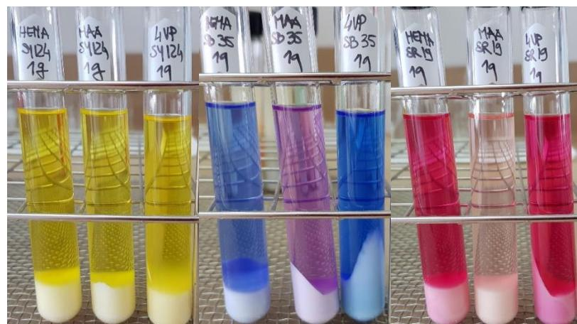
**Slika 3.18.** Polimeri s otiskom pojedinačnih bojila otopljeni u acetonu (s lijeva na desno: HEMA; MAA; 4VP)
