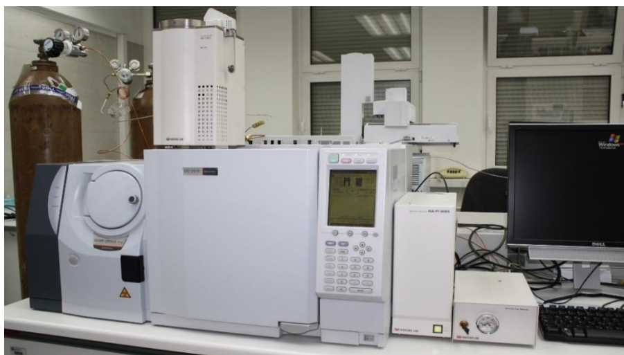
Slika 3.13. Pirolitička jedinica EGA/Py-3030D povezana s GC-MS-QP2010
