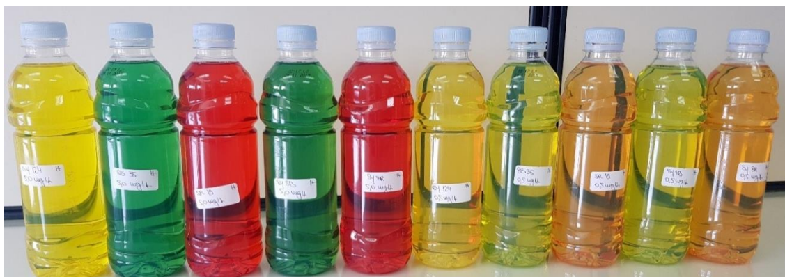
Slika 3.21. Otopine diesela, označene pojedinačnim bojilima i njihovim kombinacijama, koncentracija 0,5 i 5,0 mg/L korištene za ekstrakciju čvrstom fazom
