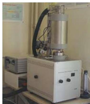
**Slika 3.12.** Simultani DTA/TGA analizator „Netzsch STA 409“
