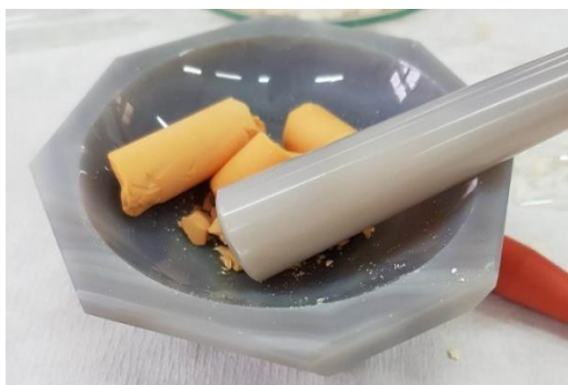
Slika 3.17. Usitnjavanje dobivenih MIP-ova i NIP-ova u tarioniku
