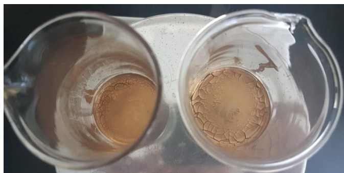
Slika 15. Talog Ag-PMA dobiven nakon sušenja.
