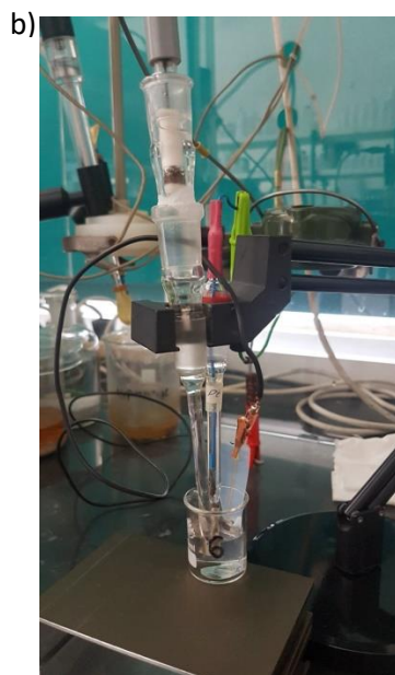
Slika 11. Prikaz a) potenciostata; b) troelektrodne ćelije korištene pri potenciostatским mjerenjima.
