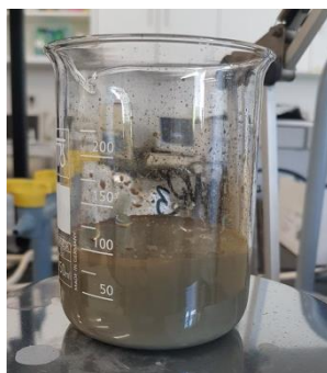
Slika 13. Reakcijska smjesa \text{AgNO}_3 i \text{NaOH} .
