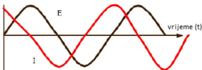
Slika 20. AC val za primjenjeni potencijal i rezultirajuću struju [23].
