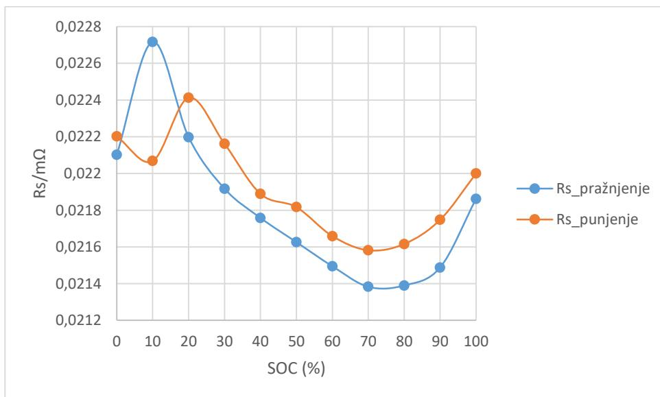
Slika 45. Grafički prikaz promjene Rs s promjenom SOC-a.
