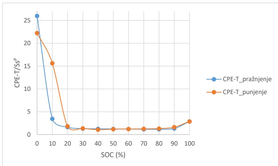
Slika 46. Grafički prikaz promjene CPE-T s promjenom SOC-a.
