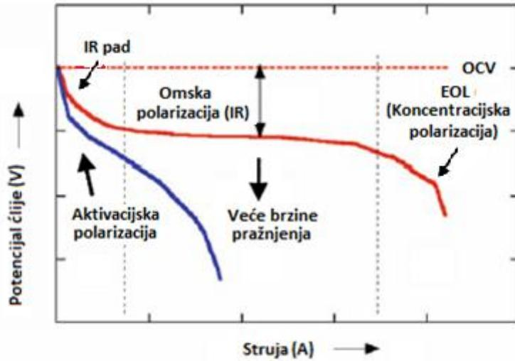
Slika 3. Tipična polarizacijska krivulja. Pad napona ( $E_{OCV} - E$ ) =  $\eta(I)$  tipične krivulje mjeru je otpora članka  $R_u(I)$  [2].
