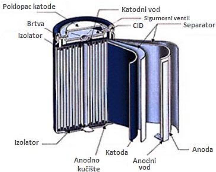
Slika 27. Struktura cilindričnog litij-ionskog galvanskog članka [7].
