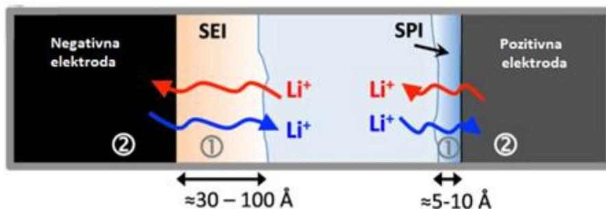
Slika 10. Shematski prikaz SEI sloja na površini elektrode [14].
