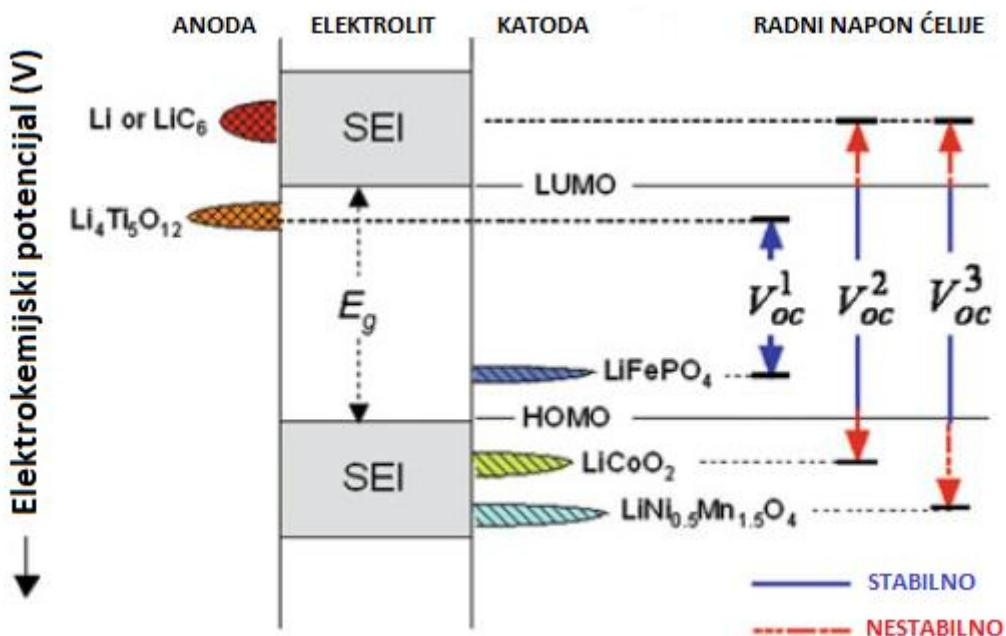
Slika 9. Elektronski energijski dijagram litij-ionskih galvanskih članaka s različitim elektrodama : *LiFePO<sub>4</sub>, LiCoO<sub>2</sub> i LiNi<sub>0.5</sub>Mn<sub>1.5</sub>O<sub>4</sub>* kao katode i litij-metal i ugljik anodama.  $E_A$  i  $E_K$  predstavljaju Fermijev nivo anode i katode.  $E_g$  je raspon potencijala elektrolita koji osigurava termodinamičku stabilnost.  $E_A > E_L$  i  $E_C < E_H$  zahtjeva kinetičku stabilnost formiranja SEI sloja [2].
