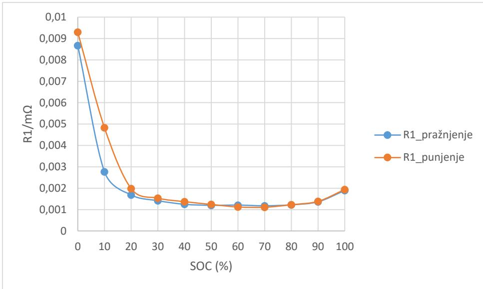
Slika 48. Grafički prikaz promjene  $R1$  s promjenom SOC-a.
