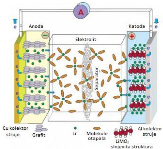
Slika 7. Shematski prikaz litij-ionskog galvanskog članka [11].
