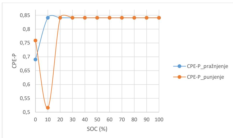
Slika 47. Grafički prikaz promjene CPE-P s promjenom SOC-a.
