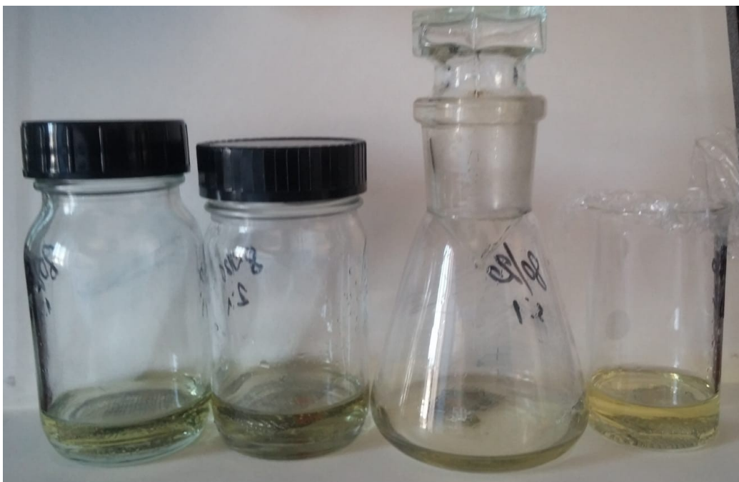
Slika 27. Uzorci s lijeva na desno 1:1/m_{CEL}/hom , 2:1/m_{CEL}/hom te 3:1/m_{CEL}/hom i celuloza u metalnim mrežastim nosačima tijekom ispitivanja apsorpcije u suspenziji dieselskog goriva i vode, w(\text{dieselsko gorivo}) : w(\text{voda}) = 0,8:0,2
