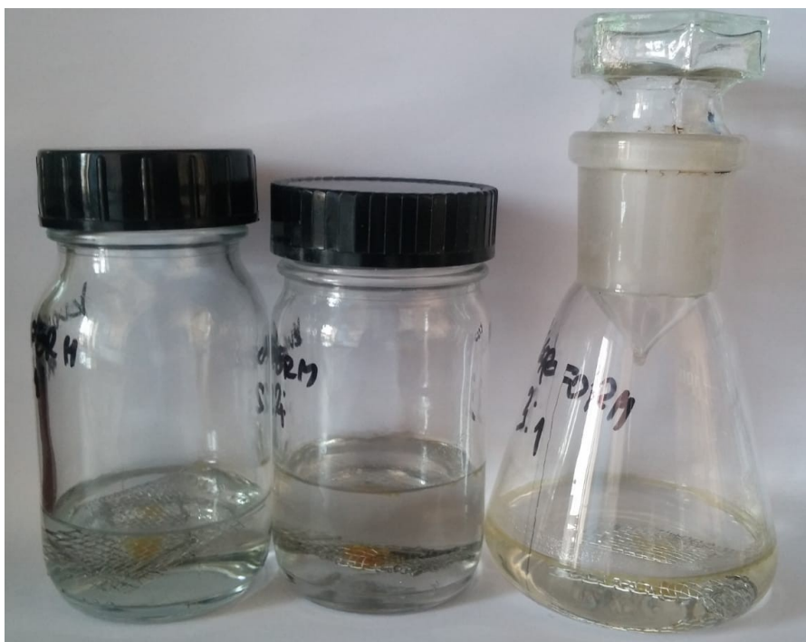
Slika 22. S lijeva na desno uzorci 1:1/mCEL/hom , 2:1/mCEL/hom te 3:1/mCEL/hom i celuloza u metalnim mrežastim nosačima tijekom bubrenja u kloroformu
