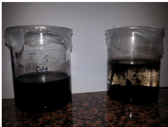
Slika 3.3. Prikaz otopine grafen oksida prije i otopine grafena poslije redukcije
