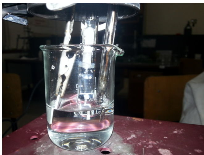
Slika 3.9. Prikaz troelektrodnog sustava – radne, referentne i protuelektrode
