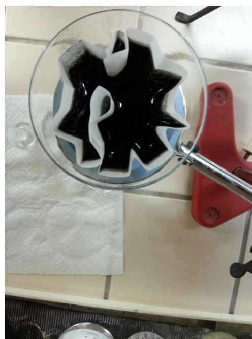
Slika 3.4. Prikaz filtriranja otopine grafena kroz filter papir
