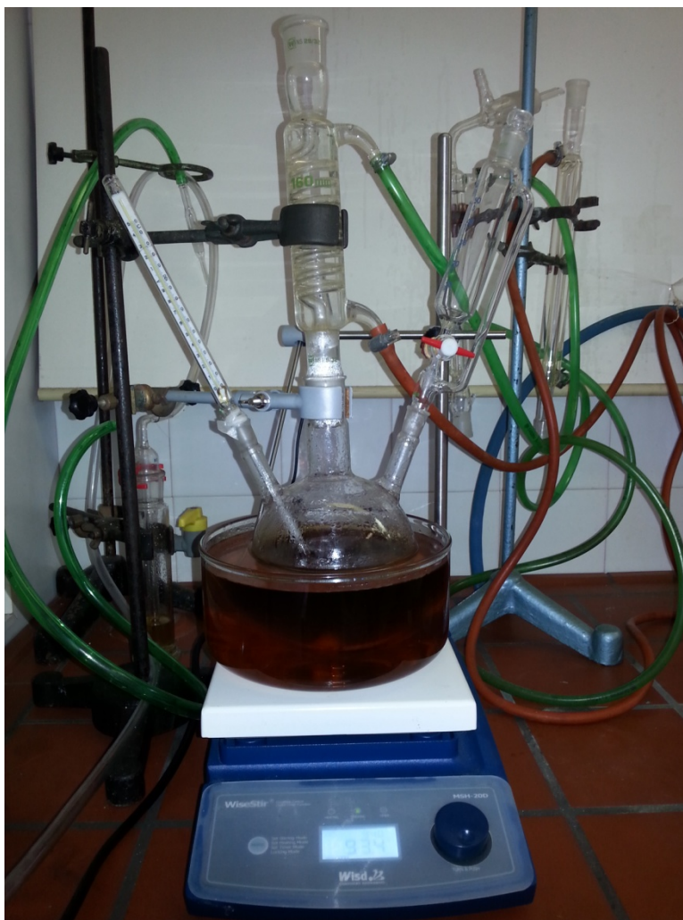
Slika 3.2. Redukcija grafen oksida u grafen
