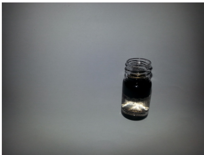
Slika 3.5. Prikaz prijelaza grafena iz vode u 1-metil-2-pirolidon.
