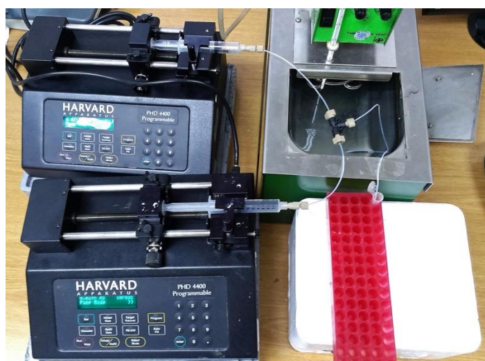
Slika 10. Mikroreaktorski sustav za dobivanje biodizela i ekstrakciju glicerola
