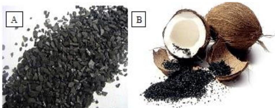
Slika 6. A: Komercijalni granularni aktivni ugljen<sup>[46]</sup> B: Granularni aktivni ugljen proizveden od kokosove ljske<sup>[47]</sup>
