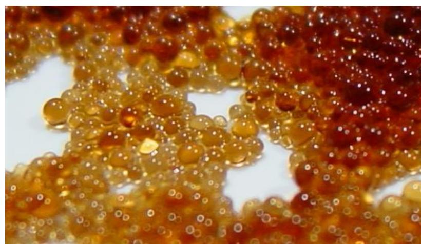
Slika 3. Kuglice ionskog izmjenjivača<sup>[16]</sup>
