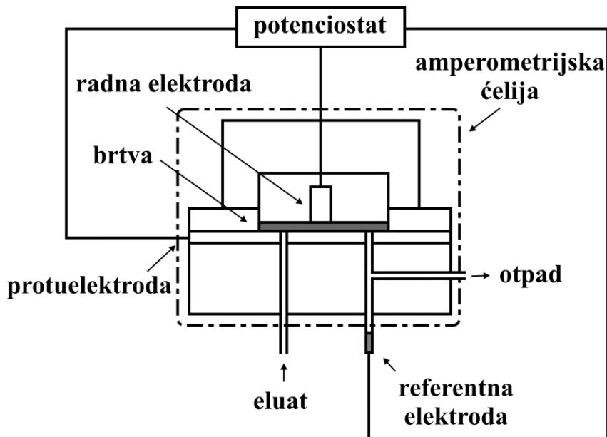
**Slika 8.** Amperometrijski detektor.
