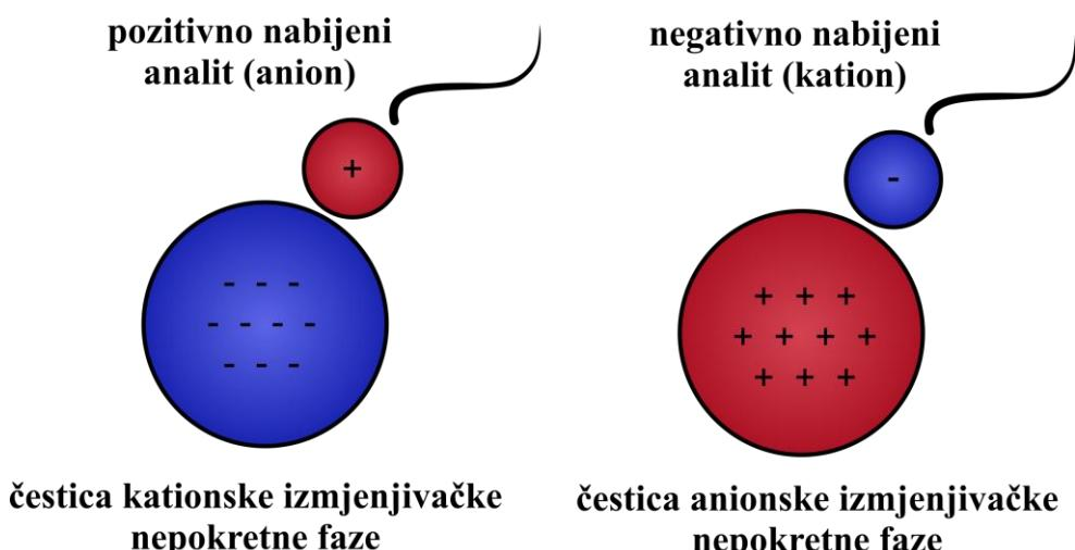
Slika 3. Ionski izmjenjivači.
