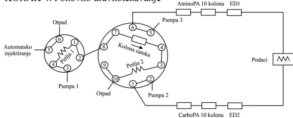
**Slika 10.** Shema aparature za IC analizu u kulturi *Clostridium Thermocellum*.<sup>124</sup>
