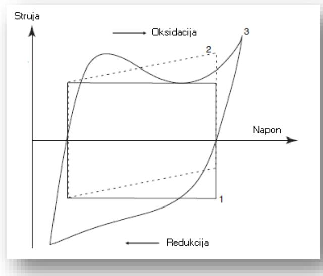
Slika 2.10. Ciklički voltamogram: 1. idealni kondenzator, 2. kondenzator s unutarnjim otporom, 3. superkondenzator s pseudokapacitetom
