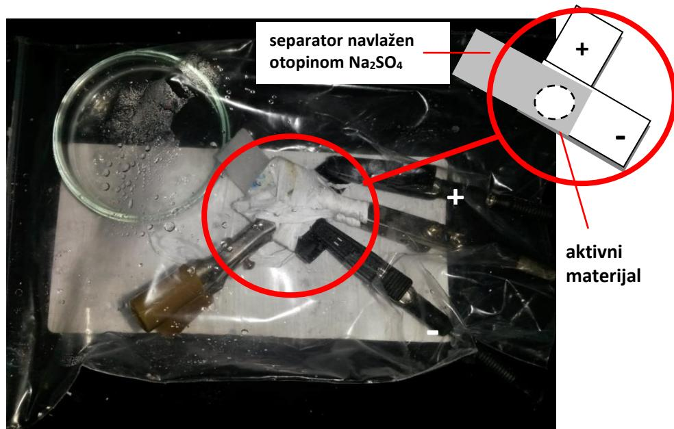
Slika 3.6. Sastavljeni superkondenzator
