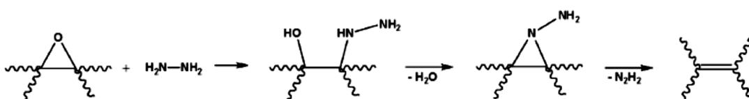
Slika 2.4. Reakcija s hidrazinom hidratom
