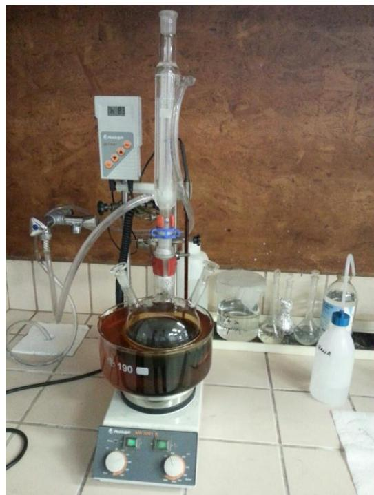
Slika 3.3. Aparatura u kojoj provedena redukcija grafena
