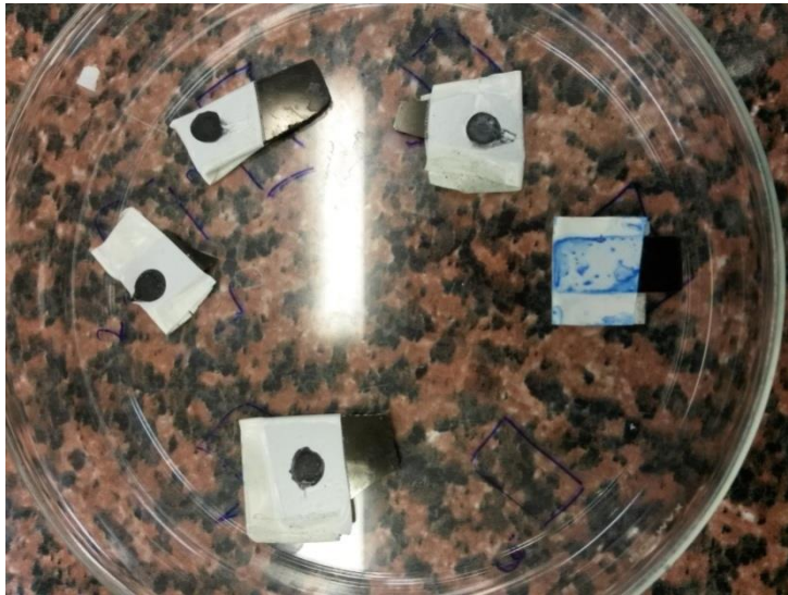
Slika 3.4. Prikaz GC elektroda na koje je nanesen uzorak grafena
