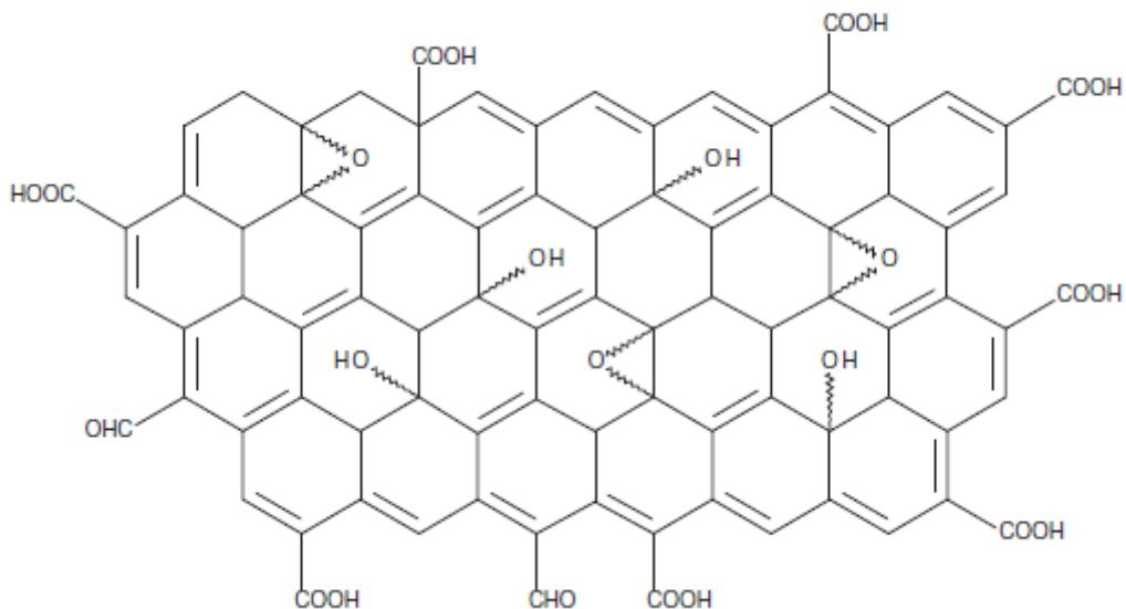
Slika 2.2. Shematski prikaz strukture grafen oksid (GO)
