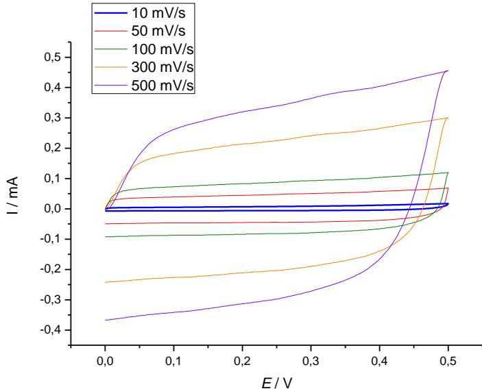
**Slika 4.2.** Ciklički voltamografi *Elektrode11* snimljeni u  $0,5 \text{ mol dm}^{-3}$   $\text{Na}_2\text{SO}_4$  pri naznačenim brzinama promjene potencijala
