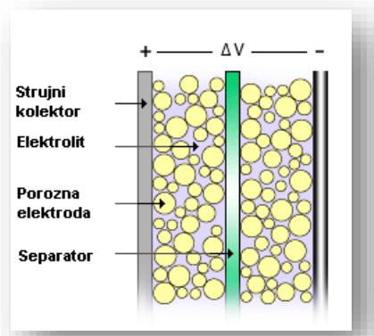
Slika 2.6. Pojednostavljena shema superkondenzatora
