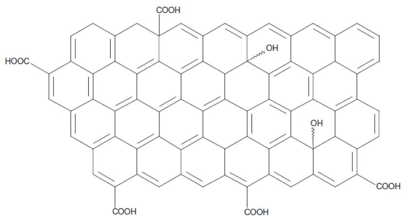
Slika 2.3. Shematski prikaz strukture reduciranog grafena oksida (rGO)
