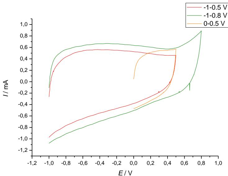
**Slika 4.5.** Ciklički voltamogrami *Elektrode22* snimljeni u  $0,5 \text{ mol dm}^{-3} \text{Na}_2\text{SO}_4$  u naznačenim granicama potencijala, pri  $v = 50 \text{ mV s}^{-1}$
