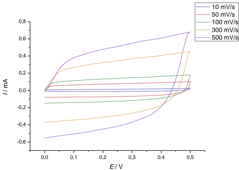
**Slika 4.4.** Ciklički voltamografi *Elektrode12* snimljeni u  $0,5 \text{ mol dm}^{-3}$   $\text{Na}_2\text{SO}_4$  pri naznačenim brzinama promjene potencijala
