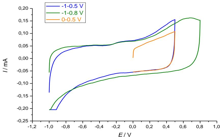
**Slika 4.1.** Ciklički voltamogrami *Elektrode11* snimljeni u  $0,5 \text{ mol dm}^{-3} \text{ Na}_2\text{SO}_4$  u naznačenim granicama potencijala, pri  $v = 50 \text{ mV s}^{-1}$
