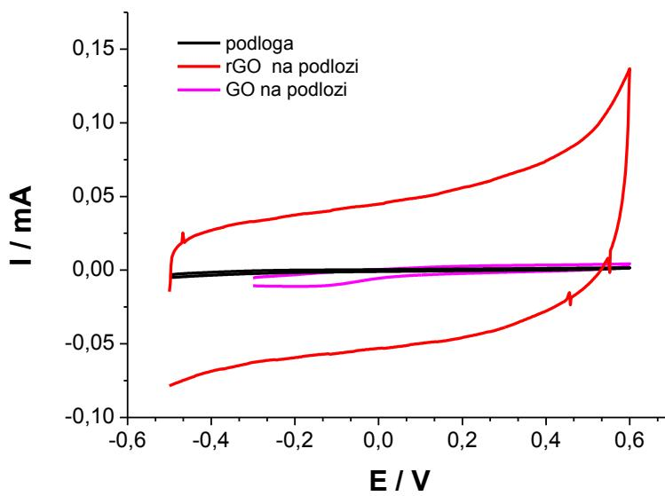
**Slika 5.1.** Ciklički voltamogram zabilježen za rGO i GO na podlozi od Pt te odziv čiste Pt u  $0,5 \text{ mol dm}^{-3} \text{ Na}_2\text{SO}_4$  [1] .
