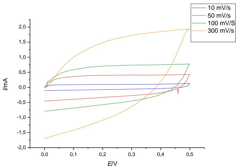
**Slika 4.6.** Ciklički voltamografi *Elektrode22* snimljeni u  $0,5 \text{ mol dm}^{-3} \text{Na}_2\text{SO}_4$  pri naznačenim brzinama promjene potencijala
