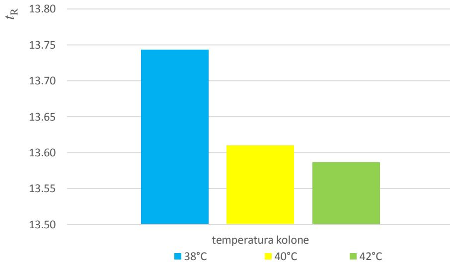
**Slika 30.** Grafički prikaz utjecaja promjene temperature kolone ( $^{\circ}\text{C}$ ) na na promjenu vremena zadržavanja za HCQ otopinu koncentracije 1 mg/L, MilliQ voda
