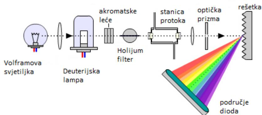
**Slika 6.** Shematski prikaz DAD detektora [12]
