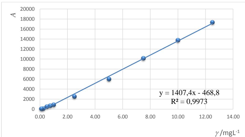
Slika 13. Umjerni pravac HCQ u MilliQ vodi pri 343,4 nm
