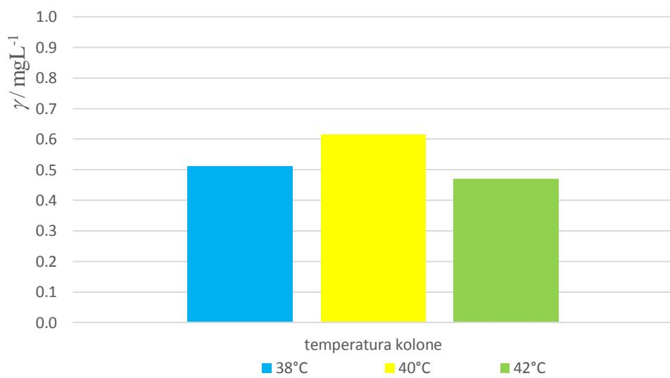
**Slika 27.** Grafički prikaz utjecaja promjene temperature kolone (°C) na određivanje HCQ u MilliQ vodi za otopinu koncentracije 1 mg/L
