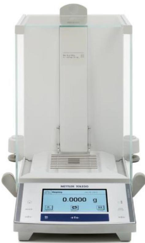
**Slika 7.** Analitička vaga XS204 DeltaRange, Mettler Toledo 15<sup>17</sup>
