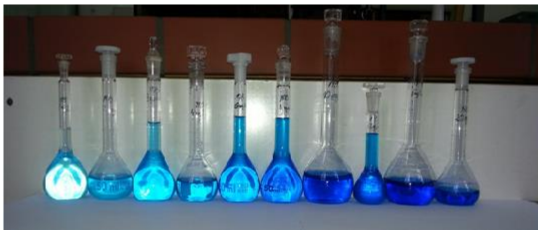
Slika 9. Pripravljene otopine metilenskog plavila različitih koncentracija.
