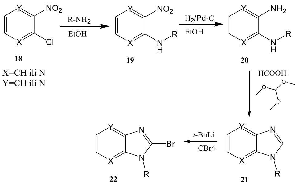
**Shema 10.** Opća shema sinteze za pripremu bromih intermedijera
