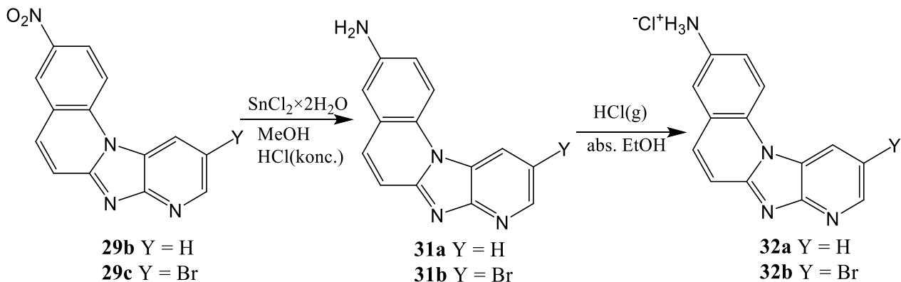
**Shema 14.** Sinteza amino supstituiranih derivata triaza-benzo[*c*]fluorena **31a-32b**
