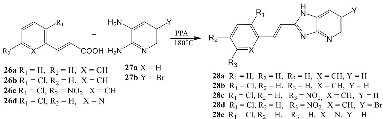
**Shema 13.** Sinteza *E*-2-stiril supstituiranih derivata imidazo[4,5-*b*]piridina **28a-28e**
