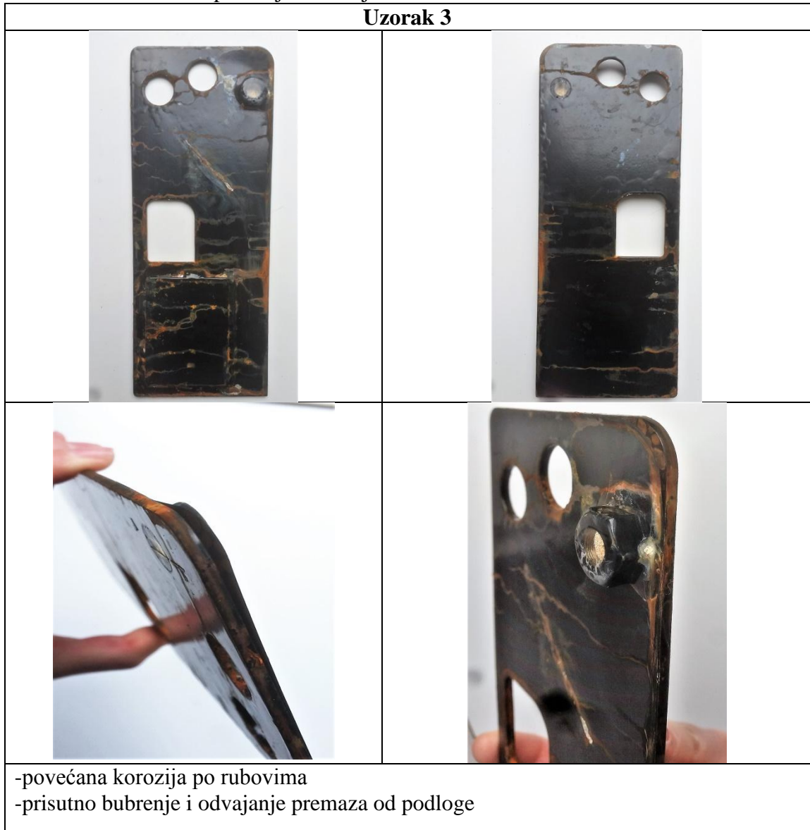
Tablica 7.: Uzorak 3 nakon ispitivanja u slanoj komori
