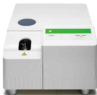
Slika 20. DSC analizator MettlerToledo DSC 822 e 28
