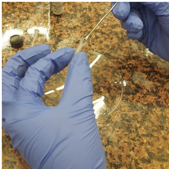
Slika 3.1. Priprema mikroelektrode od grafitne paste.
