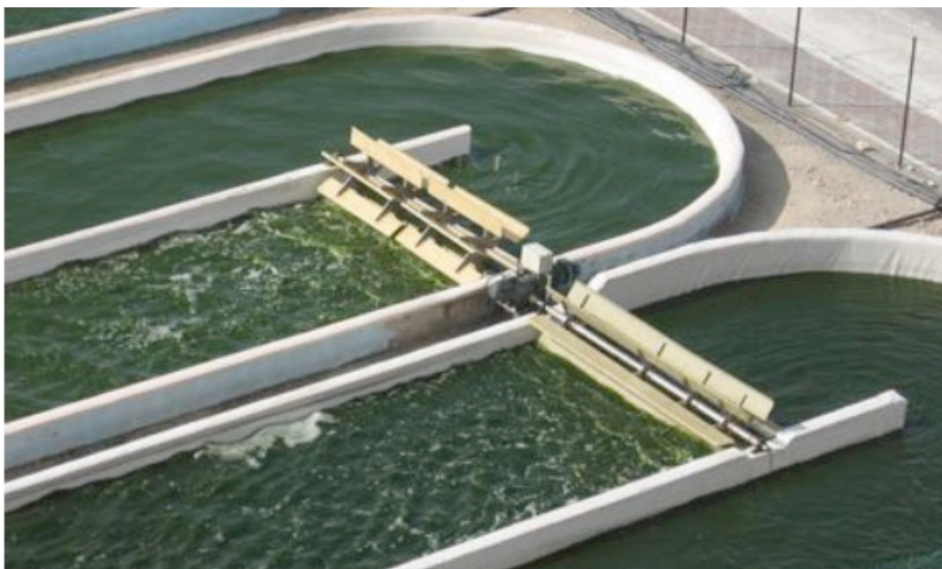
Slika 2.8: Princip otvorenog sustava proizvodnje algi 14
