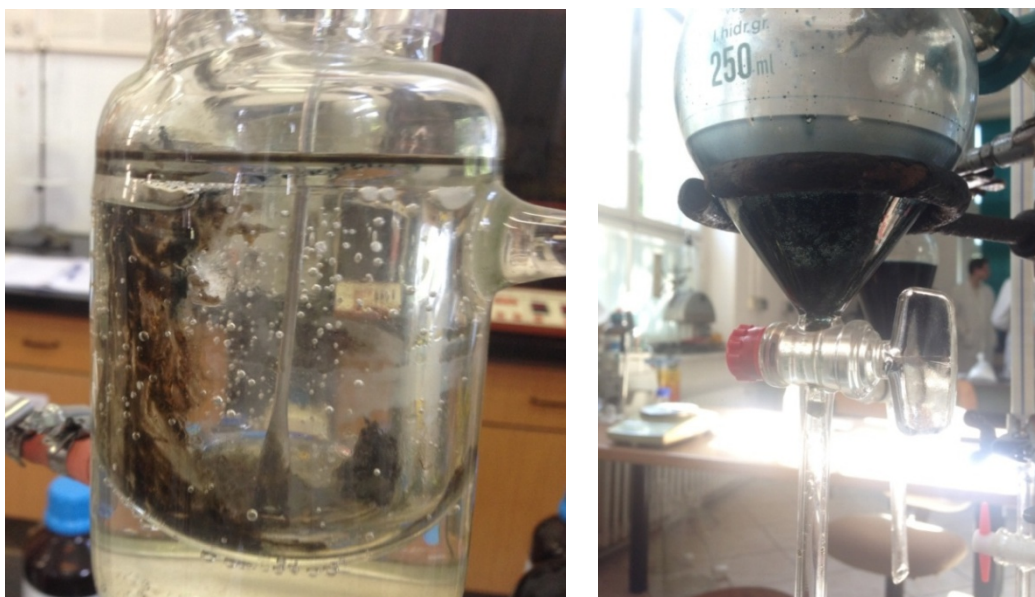
Slika 4.2: Zelenkast talog nastao kiselom esterifikacijom
