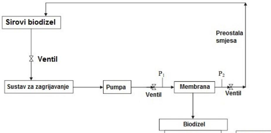
Slika 4. Shematski dijagram membranskog separacijskog sustava za pročišćavanje biodizela [19]
