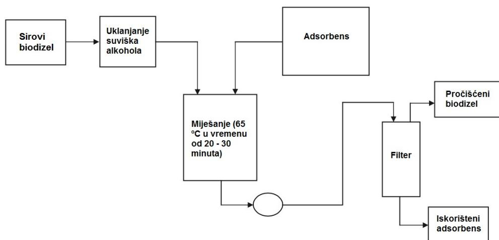
Slika 2. Shematski prikaz suhog ispiranja biodizela upotrebom adsorbensa
