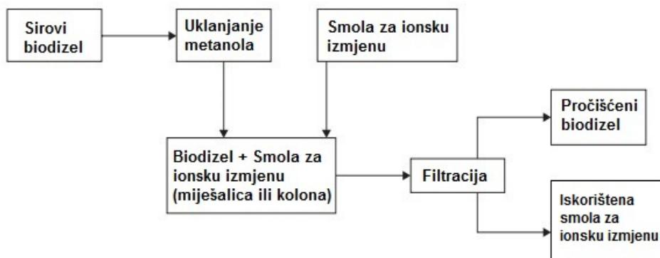
Slika 3. Shematski prikaz suhog ispiranja biodizela upotrebom smole za ionsku izmjenu [14]
